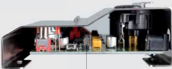
Jumper für zusätzliche Verstärkung +6 dB (Auslieferungszustand offen - nicht aktiv)
